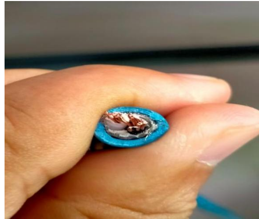
填充物不实（采用编织物）有间隙
