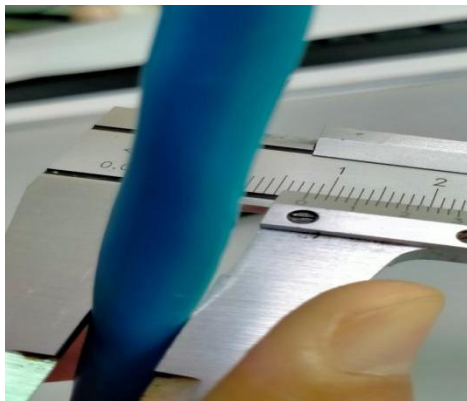
外护套薄（外径小于 9mm）
