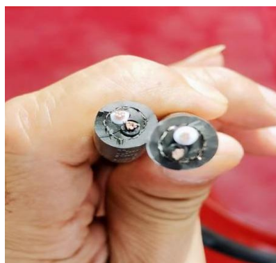
外形圆整(填充物密实, 且从内到外为一结合紧密的整体)
